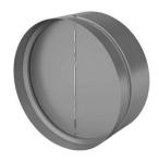
Обратный клапан SKO предназначен для предотвращения перетекания воздуха через ответвления к отключенным вентиляторам (от отключенных вентиляторов). Корпус обратного клапана изготовлен из оцинкованного стального листа. Лопатки изготовлены из листового алюминия. Автоматическое пере-
