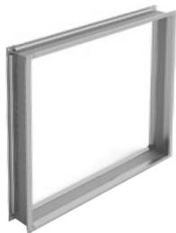
Гибкие вставки применяются для предохранения от переноса вибрации на каналы, компенсации несовпадения осей канала и выходного окна агрегата. Фланцы изготовлены из оцинкованной стали и соединены виниловым материалом.
