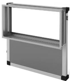
Торцевая панель применяется для предохранения от переноса вибрации на каналы, компенсации несовпадения осей канала и выходного окна агрегата.
