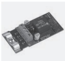
Опция является преобразователем внутреннего протокола контроллера в открытый протокол LonWorks, используемый в системе комплексного управления и диспетчеризации здания.
