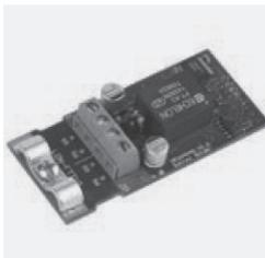
Опция является преобразователем внутреннего протокола контроллера в открытый протокол Modbus, используемый в системе комплексного управления и диспетчеризации здания.
