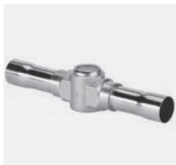
Устройство осуществляет индикацию состояния хладагента в холодильном контуре: наличие или отсутствие влаги, утечки, засорения фильтра осушителя.
