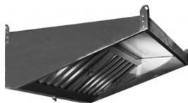
Зонты вытяжные с лабиринтным жироуловителем служат для вытяжки и очистки горячего воздуха и паров от жира и масла. Корпуса зонтов изготавливаются из нержавеющей стали марки AISI 430. При специальном заказе, возможно изготовление корпусов зонтов из оцинкованной стали, со специальным порошковым покрытием по RAL.
