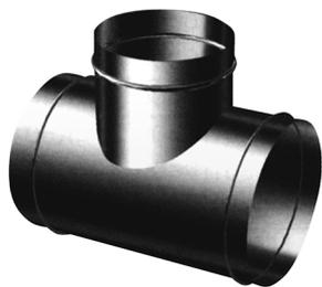
Тройники используются для разводки по горизонтали или вертикали сети воздуховодов. Тройник представляет собой прямой участок воздуховода с врезанной в него врезкой. Тройник круглого сечения может быть с круглой или прямоугольной врезкой.
