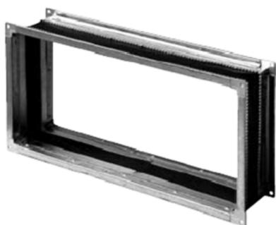
Гибкие вставки предназначены для предотвращения передачи вибраций от вентилятора к воздуховодам и для обеспечения герметичного гибкого стыка, который выдерживает высокое давление. Гибкие вставки нельзя использовать в качестве несущей
