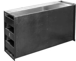
Шумоглушитель ГП — это воздуховод прямоугольного сечения, разделенный вдоль прохода воздуха пластинами, наполненными звукопоглощающим материалом. Для уменьшения гидравлического сопротивления и уровня звукового шума, со стороны входа воздушного потока перед пластинами устанавливаются обтекатели.
