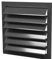
Решетка инерционная SGI является наружной решеткой и выполняет дополнительно функции обратного клапана. Она защищает вентиляционную систему от попадания в нее осадков и посторонних предметов; не допускает движение воздуха в системе при отключенном вентиляторе.
