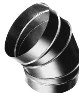
Стандартные круглые отводы изготавливаются с углами поворота 90, 60, 45, 30 и 15°. Радиус поворота  $R$  в стандартном отводе равен его диаметру  $D$ .
