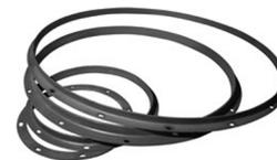
Фланец круглый применяется для соединения воздуховодов и фасонных изделий между собой. Он представляет собой кольцо, изготовленное из стальной полосы или стального уголка. По окружности фланца располагаются крепежные отверстия, количество которых зависит от диаметра, но оно всегда четное.
